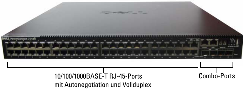
Abbildung 1-6. PowerConnect 7048R mit 48 10/100/1000BASE-T-Ports
