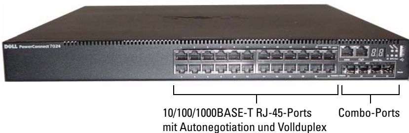
Abbildung 1-2. PowerConnect 7024P mit 24 10/100/1000BASE-T PoE Plus-Ports
